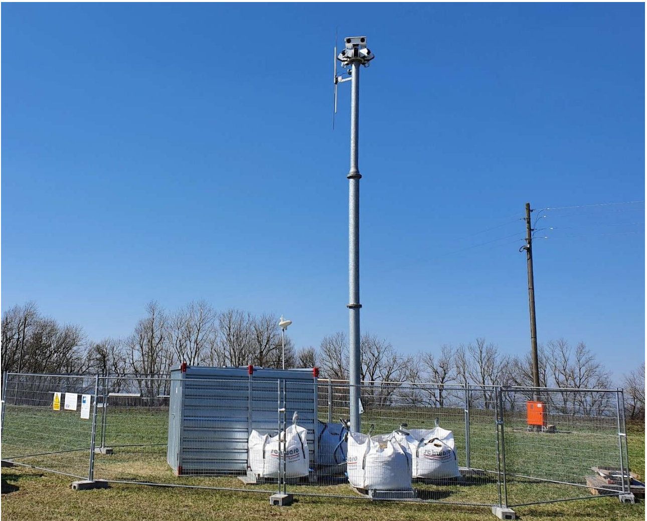
Figure 1 : Système IDF installé avec une hauteur de mât de 10 m.
