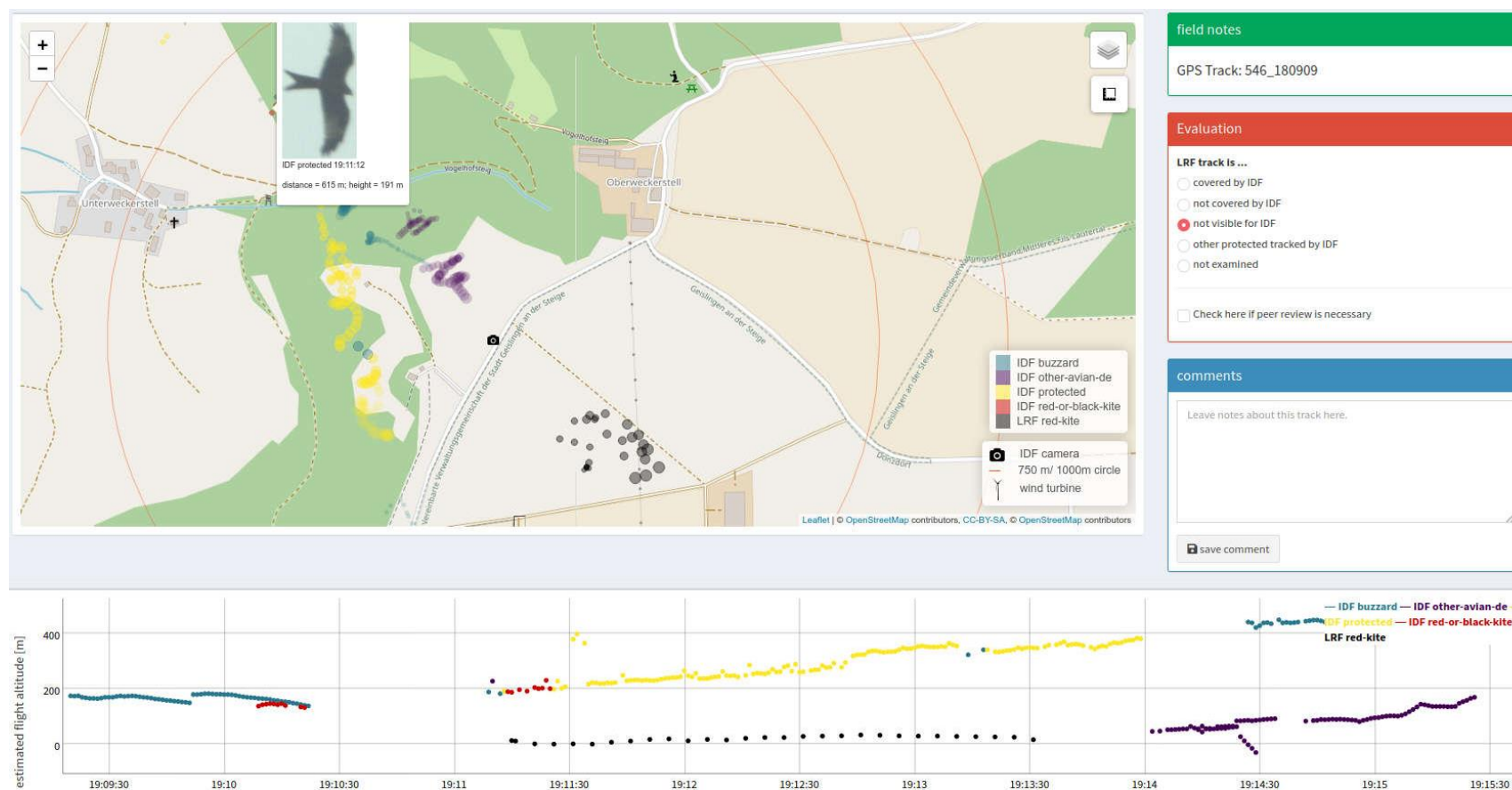
Figure 56 : Milan royal volant à basse altitude « Donzi » (données GPS, points gris ; marqué de manière déviée par « LRF red kite » sur la figure), qui n'est pas détecté par IDF. Au même moment, IDF a enregistré un autre Milan royal (points rouges et jaunes). Site de Geislingen, 27/04/2020.
