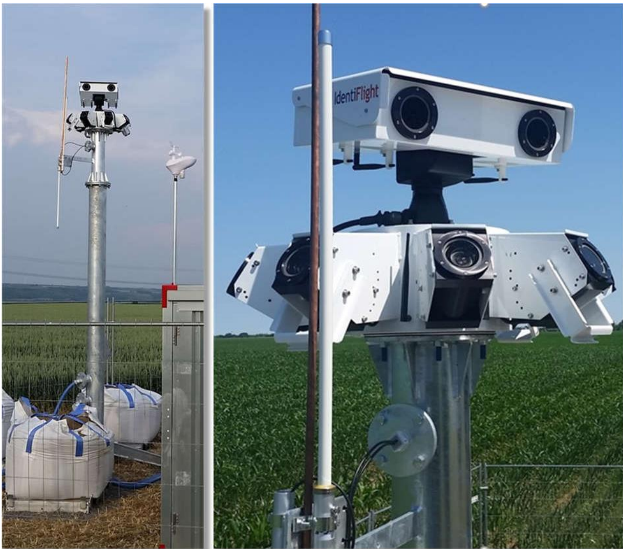
Figure 2 : Système IdentiFlight, composé de 8 caméras grand angle et d'une caméra stéréo mobile.
