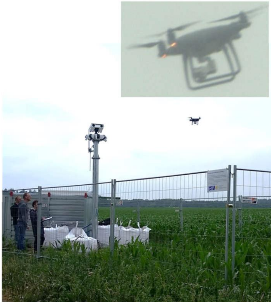
Figure 26 : Test de détection avec un drone localisé par GPS. La petite image montre une photo du drone prise par IDF à une distance d'environ 150 m.
